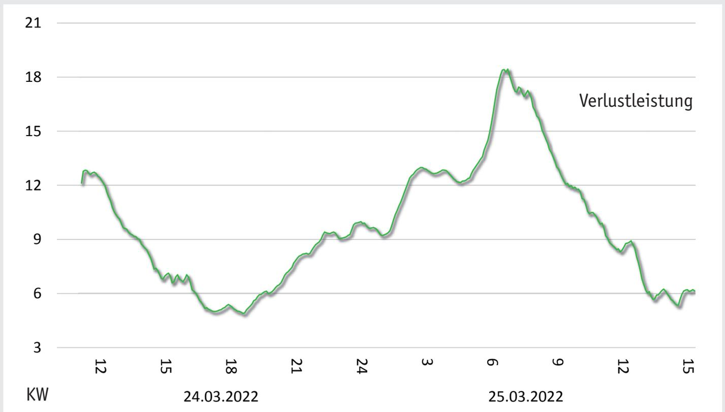
Die Abbildung zeigt auf, wieviel Wärmeleistung durch eine permanent offene Rauchabzugsöffnung verloren geht. Die Messung wurde an einem 25m hohen Aufzugschacht in einem Hamburger Klinikum durchgeführt (Einzelanlage, Bettenaufzug, 8 Haltestellen/Zugänge).
