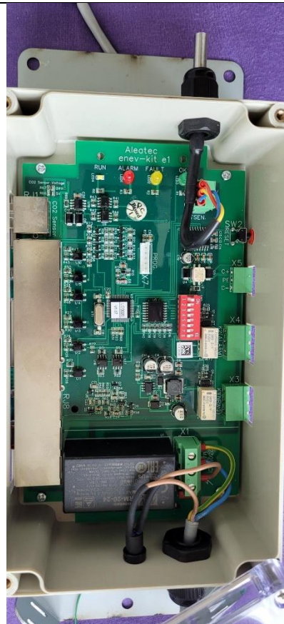
e-control Leiterplatte mit Temperaturüberwachung
